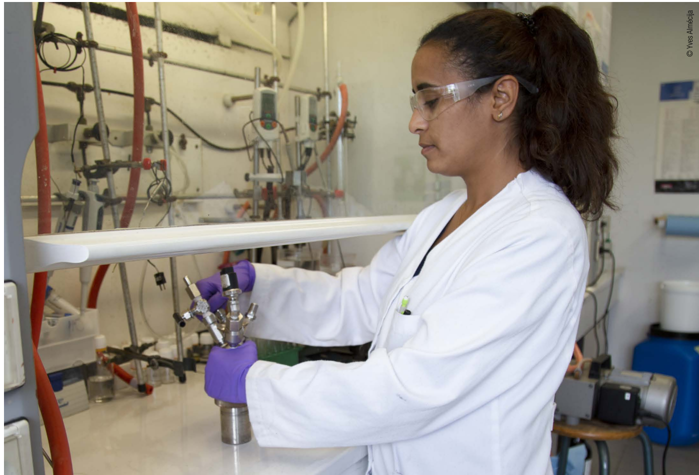
Dans le réacteur sous pression muni d'un catalyseur, on introduit les sucres issus de la biomasse. Après réaction, le réacteur est ouvert pour analyser la nature des produits formés (tensioactifs).
